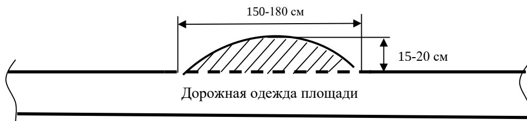
Рисунок 4.9 – Устройство въезда на открытую площадку
