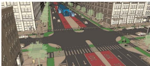
Рис. 2 – Двусторонний автобусный коридор, который размещен по оси двусторонней дороги
