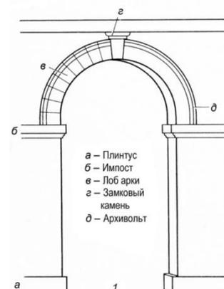
Аркалардың контуры қысым сызығына жақын таңдалады. Доғаның аккорды бойымен симметриялы, біркелкі бөлінген жүктеме кезінде (жұмсақ доғаларда) төртбұрышты параболаның бойындағы арка контуры ең тиімді болып табылады. Парабола жиі шеңбер доғасымен ауыстырылады, ол жұмсақ аркаларда күштің айтарлықтай өзгеруіне әкелмейді, бірақ аркалардың дизайны мен өндірісі айтарлықтай жеңілдетілген, өйткені доғаның тұрақты қисаюымен ең үлкен стандарттау құрылымдық элементтер мен арка түйіндеріне қол жеткізіледі.
