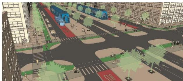
Рис. 3 – Автобусный коридор, который размещен вдоль внутренней обочины боковой дороги, где центральная проезжая часть отделена от параллельно идущих боковых дорог
