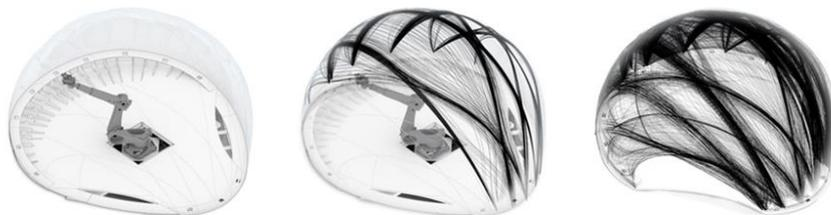
Рис. 2 – Процесс изготовления армирования
