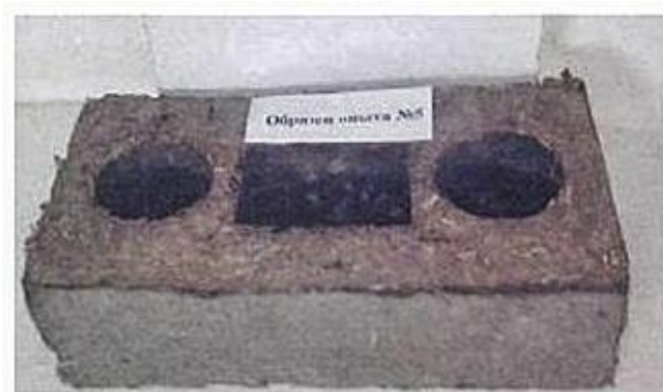
2-сурет – Қож-сілтілі байланыстырғыштан жасалған арболит блогі
