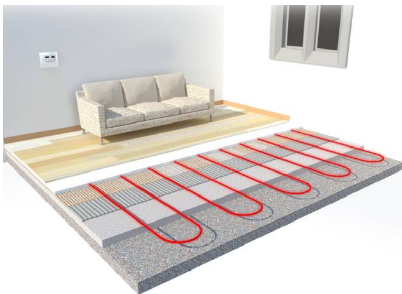
Рис. 2 – Разрез пола систем водяного отопления
