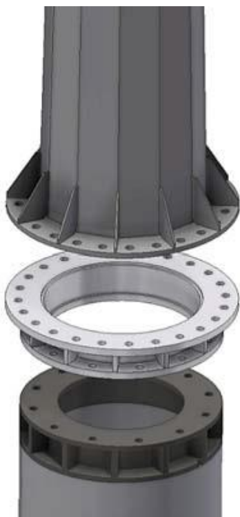
Рис. 7 – Переходной элемент для закрепления многогранных опор на железобетонном фундаменте
