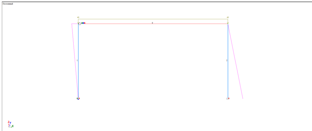
Рис. 6 – Исходное деформированное состояние рамы (а), для случая (2).
